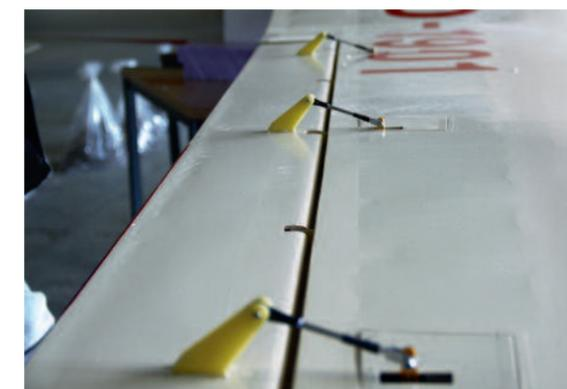
Die Anlenkung der Querruder im Detail, pro Klappe werden drei Servos verwendet.
