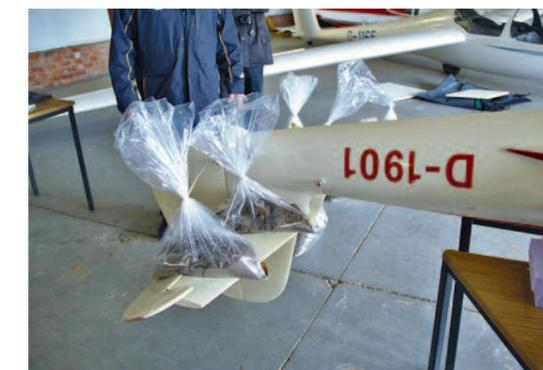
Das Höhenleitwerk wird belastet.
