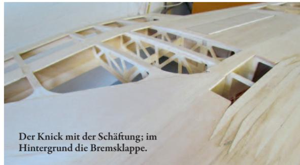
Der Knick mit der Schäftung; im Hintergrund die Bremsklappe.
