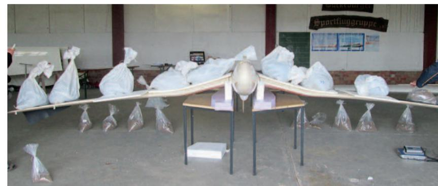
Beim Belastungstest wurde die Tragfläche mit 210 kg Sand belastet.
